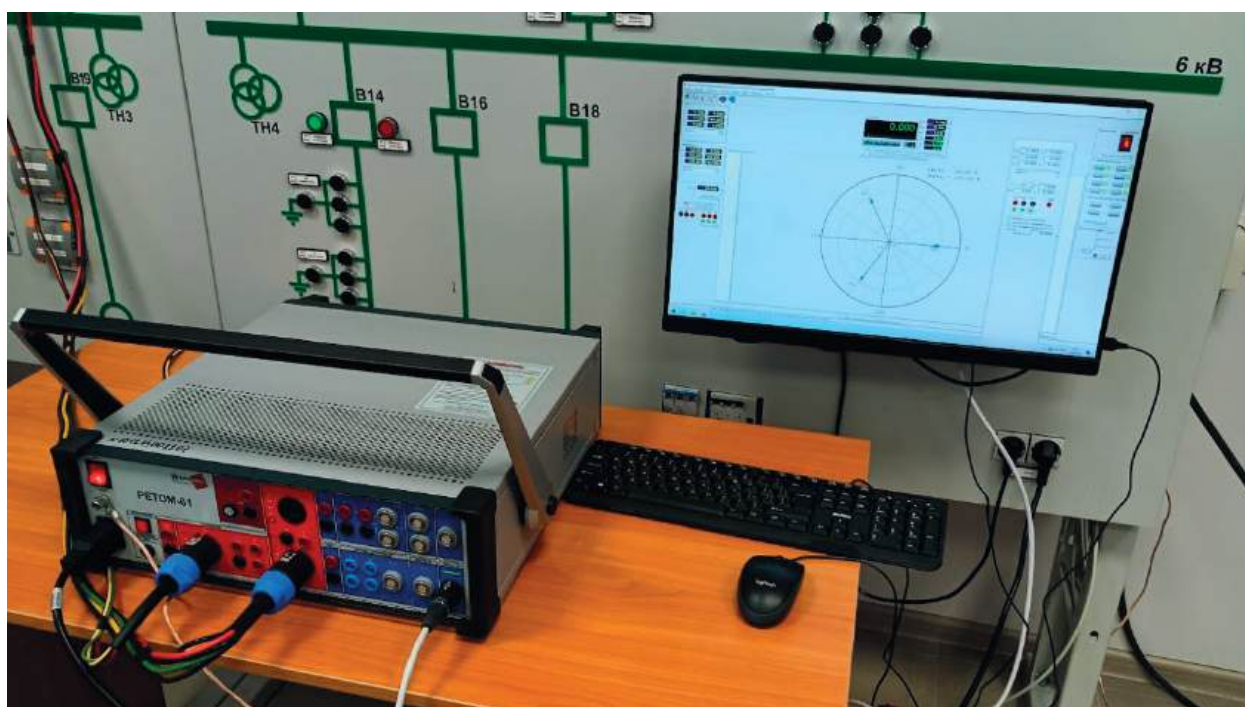
Рисунок 7. Исследование защитных характеристик микропроцессорных блоков в лаборатории релейной защиты
