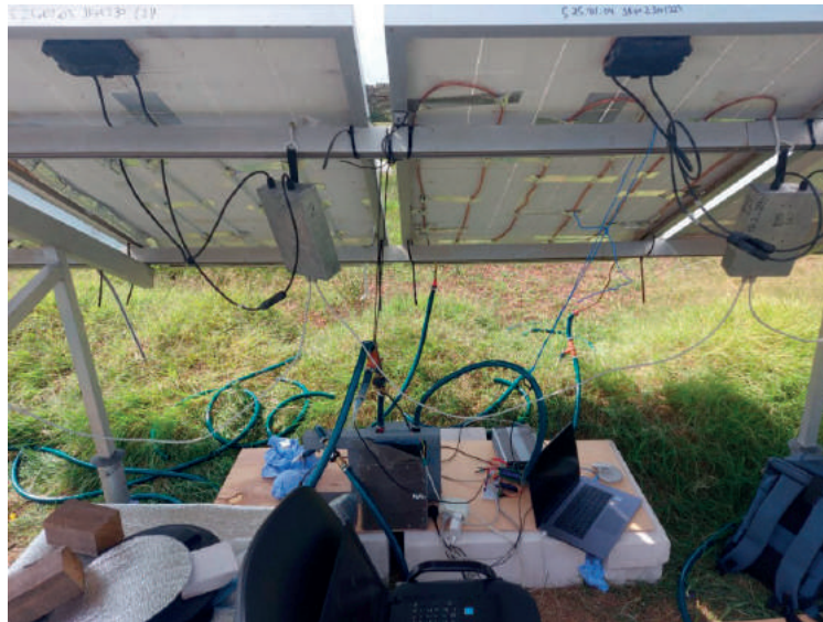
Рисунок 4. Лабораторный макет для проведения экспериментов по охлаждению солнечных панелей
