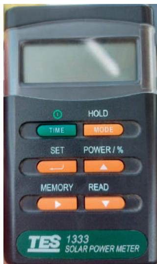
Рисунок 5. Прибор TES 1333 для измерения солнечной радиации [25]
