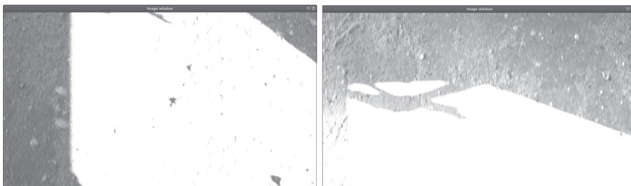
**Рисунок 6.** Изображения дорожного покрытия с сильной засветкой (слева — сильная засветка изображения и происходит разовый выброс определения скорости; справа — сильная засветка, выброса не происходит)
