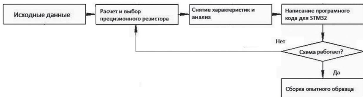
**Рисунок 4.** Алгоритм проведения исследования схемы измерения переменного тока, протекающего через испытуемый объект при испытании изоляции переменным синусоидальным напряжением промышленной частоты
