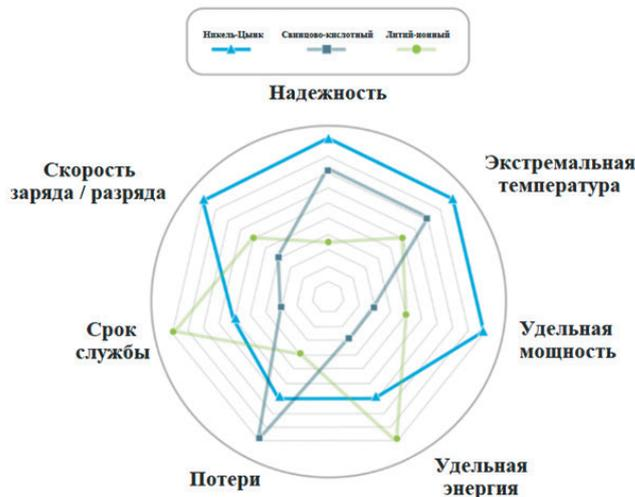
**Рисунок 3.** График сравнения литий-ионных, свинцово-кислотных и Ni-Zn батарей
