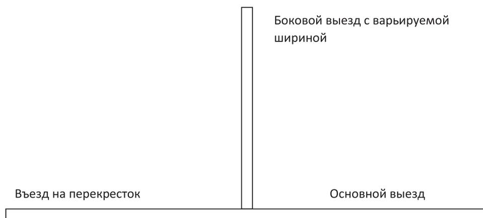
**Рисунок 5.** Схема Т-образного перекрестка с изменяемым второстепенным съездом
