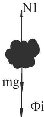
Рисунок 2. Силы, действующие на объект при перегрузке
