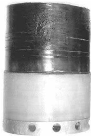
Рис. 3. Поврежденная обмотка двигателя из-за перегрева
