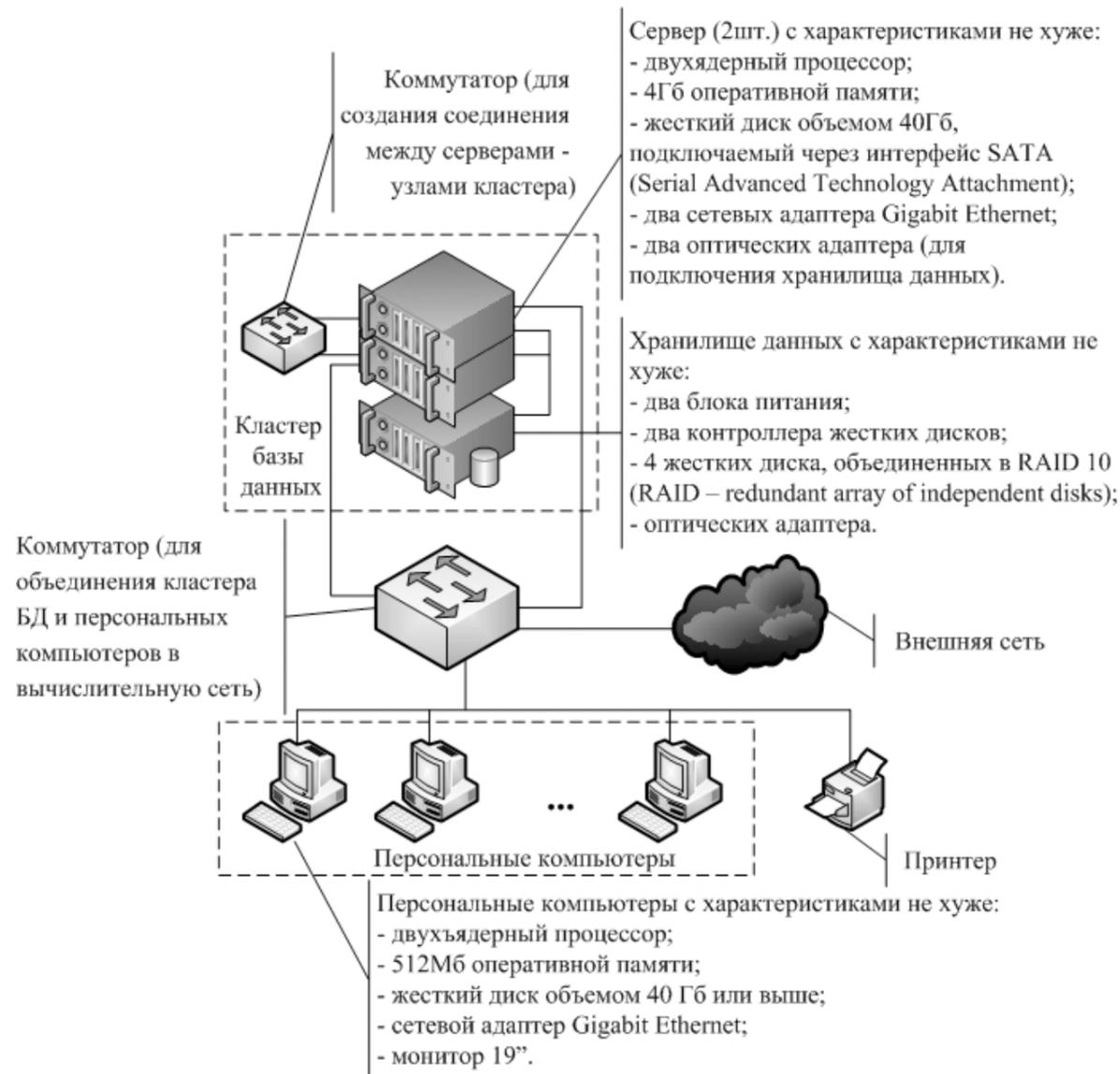
Рис. 2. Схема аппаратного обеспечения разрабатываемой автоматизированной системы
