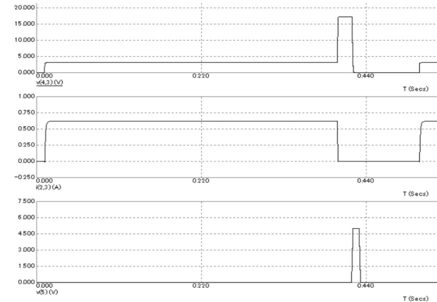
Рис.6. Временные диаграммы простейшего варианта подключения контактной площадки к аккумулятору
