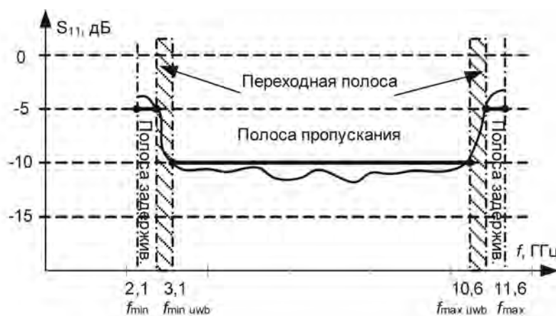
Рис. 1. Требуемая маска для коэффициента отражения S_{11}
