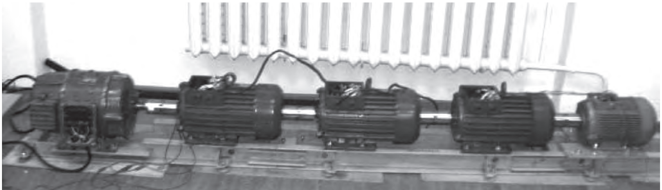
Рис. 1. Фотография действующего макета синхронно-асинхронного каскадного генератора с приводом в виде двигателя постоянного тока
