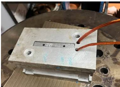
Рисунок 3. Спрессовка залитого компаундом провода в оснастке
