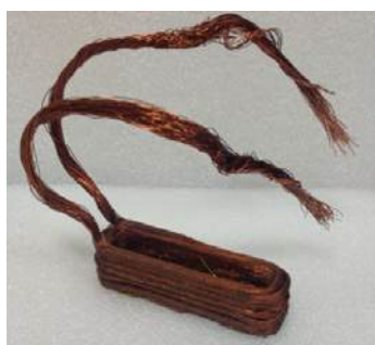
Рисунок 4. Изготовленные прессованные обмотки: из провода диаметром 0,2 мм (a); из провода диаметром 0,355 мм (b); из провода диаметром 1,0 мм (c)
