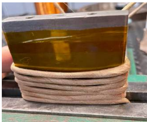
Рисунок 2. Намотка заготовленного провода на шпульку оснастки
