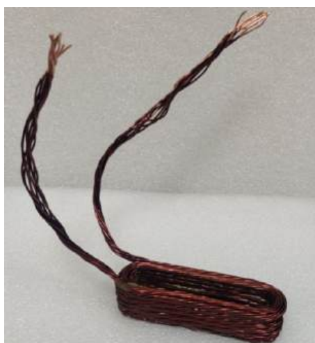
Рисунок 5. Изготовленная из литцендрата прессованная обмотка
