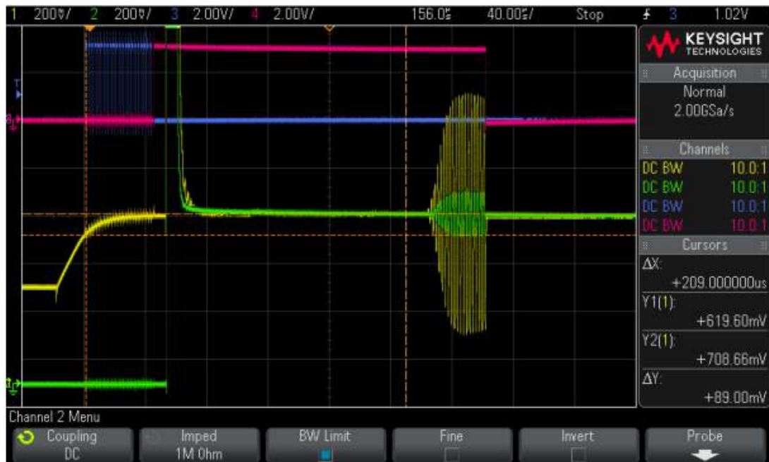
Рисунок 3. Пример передающего и приемного сигнала ультразвукового расходомера
