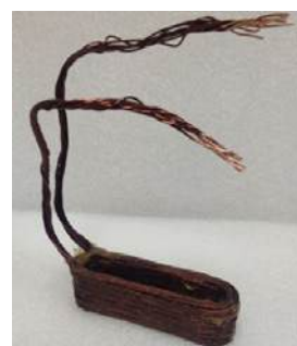
Рисунок 4. Изготовленные прессованные обмотки: из провода диаметром 0,2 мм (a); из провода диаметром 0,355 мм (b); из провода диаметром 1,0 мм (c)
