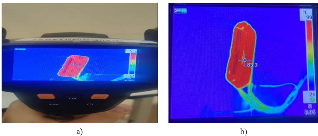
Рисунок 8. Распределение тепла «обмотки 1 литц.»: при токе 10 А (а); при токе 15 А (б)
