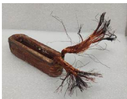
Рисунок 4. Изготовленные прессованные обмотки: из провода диаметром 0,2 мм (a); из провода диаметром 0,355 мм (b); из провода диаметром 1,0 мм (c)
