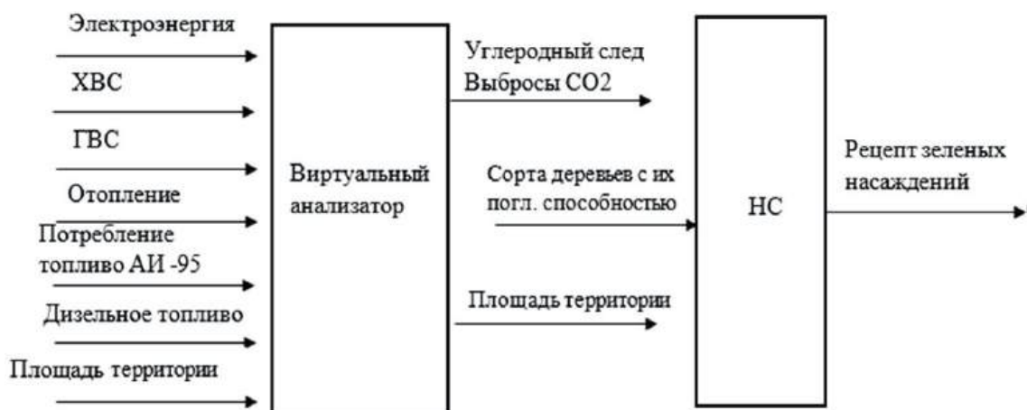
Рисунок 1. Схема входных и выходных параметров полносвязной нейронной сети по определению углеродного следа кампуса
