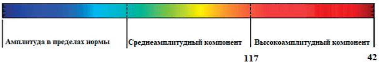
Рисунок 3. Шкала цветового распознавания амплитудной составляющей вибросигнала по вейвлет-картине
