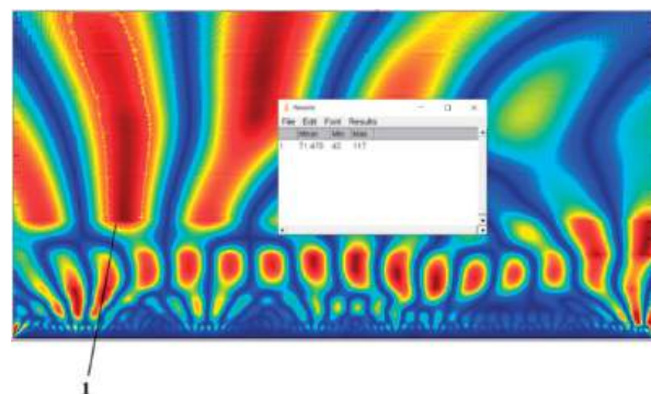
Рисунок 4. Определение площади участков высокоамплитудного компонента сигнала
