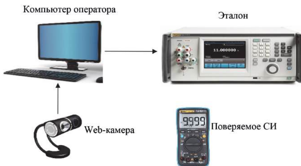
Рисунок 1. Схема подключения оборудования при автоматизированной поверке СИ
