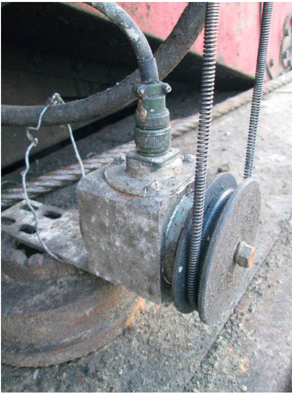
Рисунок 3. Датчик оборотов лебедки с ременной передачей крутящего момента
