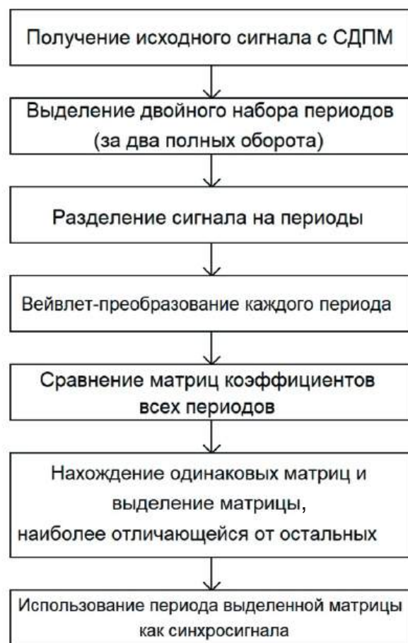
Рисунок 7. Способ синхронизации сигналов исправного и неисправного СДПМ
