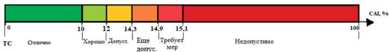
Рисунок 5. Шкала соответствия значений CAI техническому состоянию при высокоамплитудном компоненте вибросигнала неисправности типа дисбаланс ЦНА
