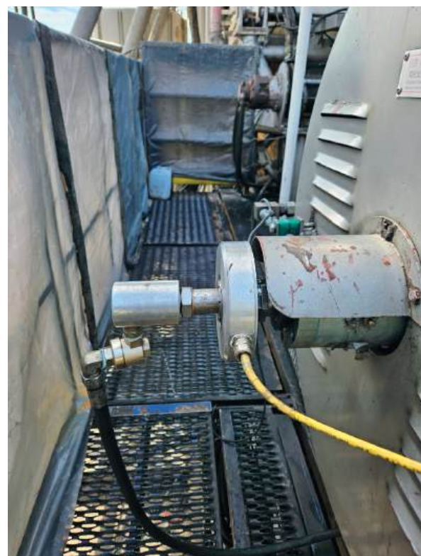
Рисунок 2. Датчик оборотов вала буровой лебедки
