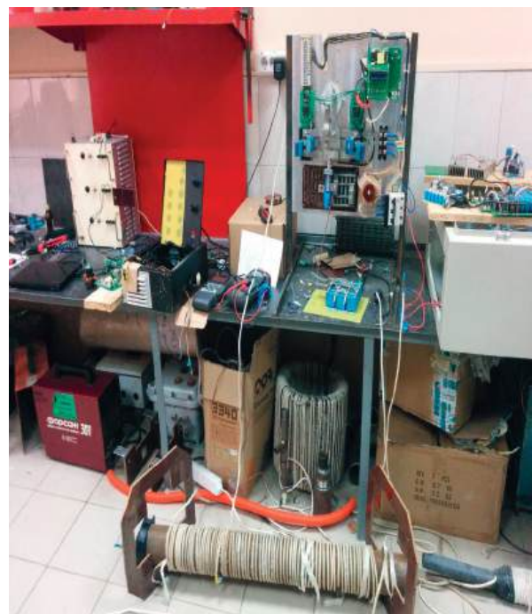
Рисунок 3. Экспериментальный стенд для испытания индукционного нагрева
