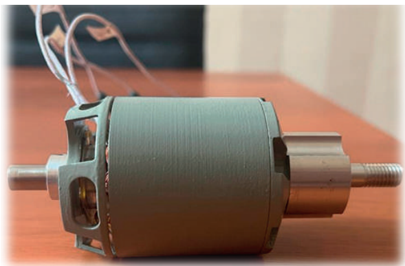
Рисунок 6. Экспериментальный образец электродвигателя для БПЛА самолетного типа
