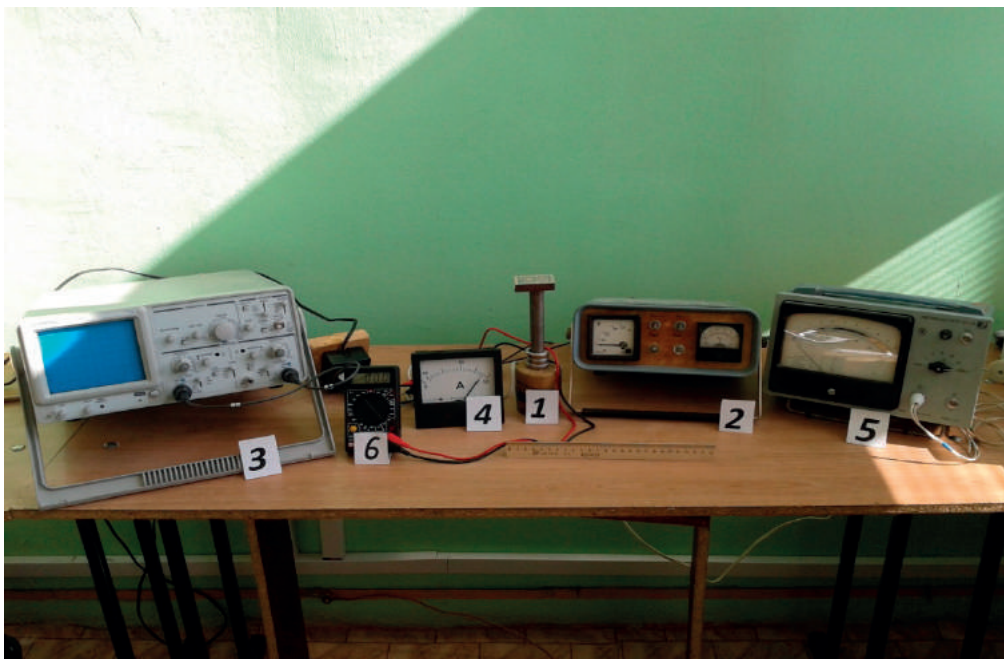
1 — экспериментальная физическая модель с короткозамкнутыми насадками (медь, алюминий, латунь, бронза); 2 — регулируемый источник переменного тока ( U = 0 \div 220 В); 3 — осциллограф (Gwinstek GOS-620); 4 — стрелочный амперметр; 5 — стрелочный вольтметр; 6 — мультитестер; 7 — измерительный штангенциркуль
