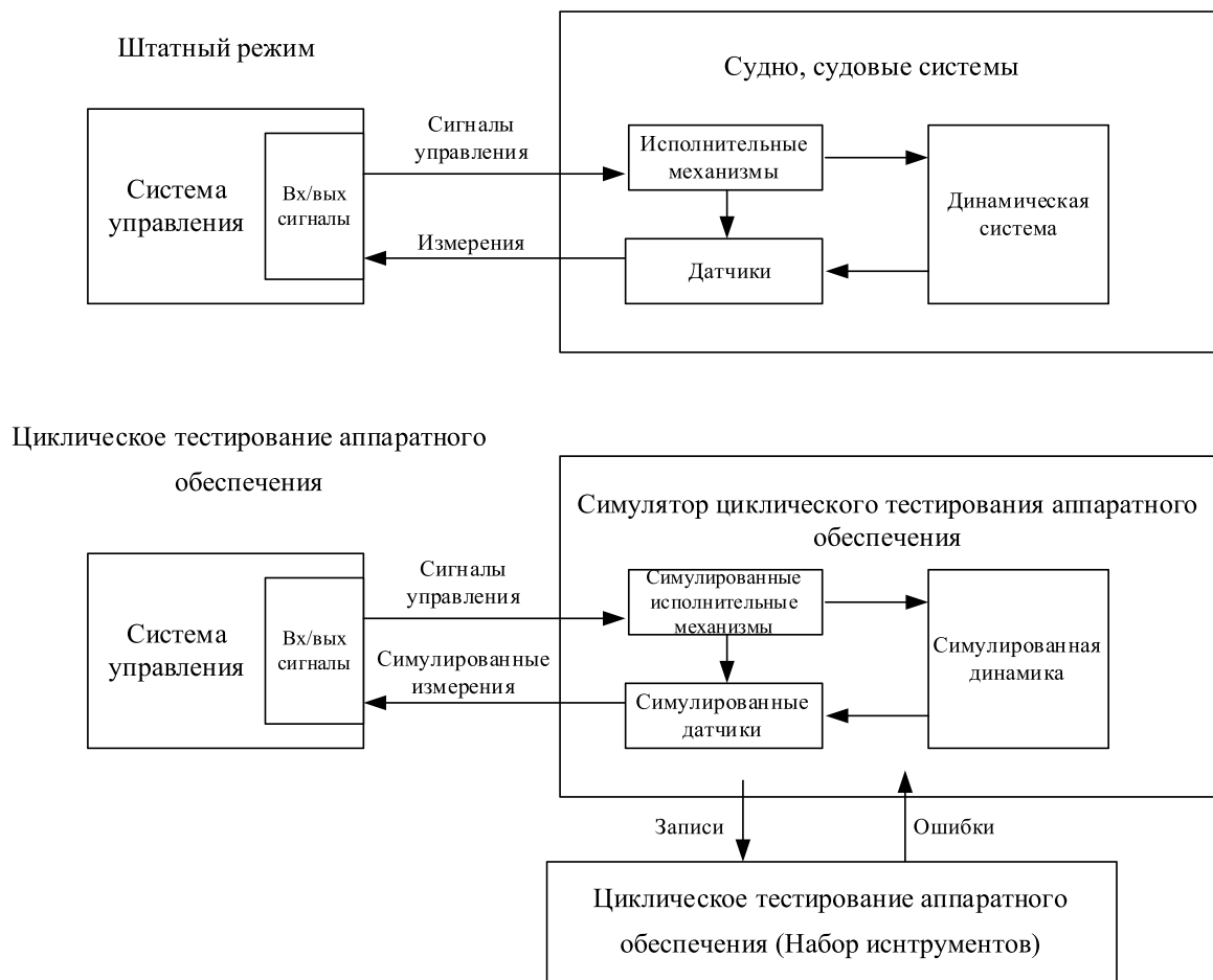
Рисунок 1. Принципиальная схема тренажера циклических аппаратных испытаний морских систем управления
