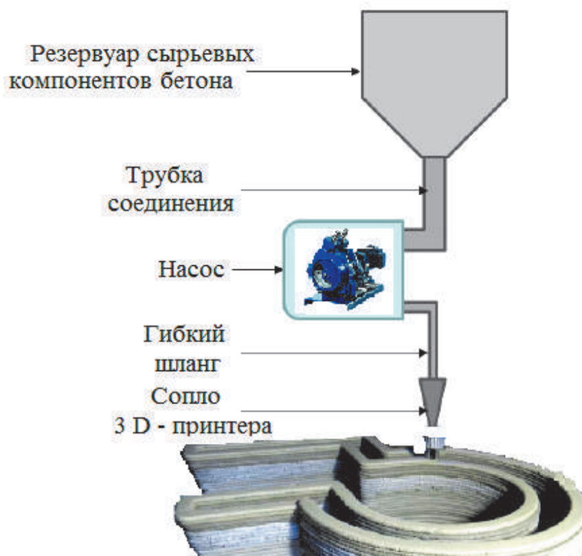
Рисунок 1. Технологическая схема функционирования 3D печати
