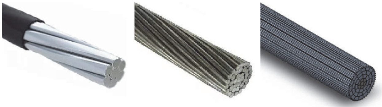
а) самонесущий изолированный провод (СИП); б) неизолированный сталеалюминиевый провод (АС); в) неизолированный энергоэффективный провод
