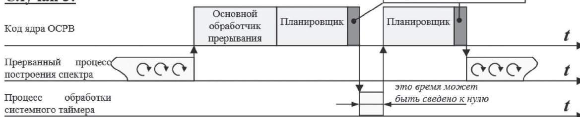
Рисунок 2. Схема возникновения задержек на планирование и переключение контекста
