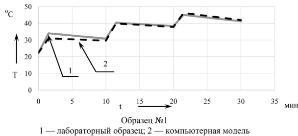
Рисунок 1. Тепловая характеристика повторно-кратковременного режима работы
