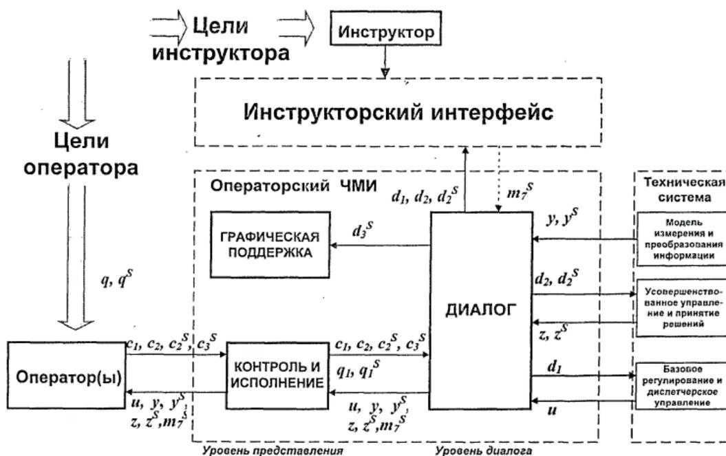
Рисунок 4. Схема устройства компьютерно-тренажёрного комплекса
