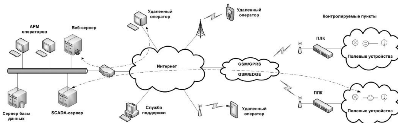
Рис. 4. Структура SCADA-системы на базе сети Интернет
