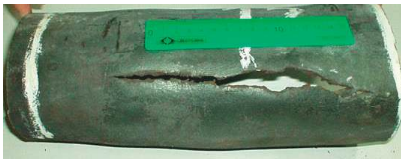
Рисунок 2. Дефекты змеевиков печей, приводящие к взрыво- и пожароопасным авариям на технологических установках
