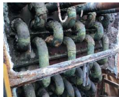
Рисунок 2. Дефекты змеевиков печей, приводящие к взрыво- и пожароопасным авариям на технологических установках
