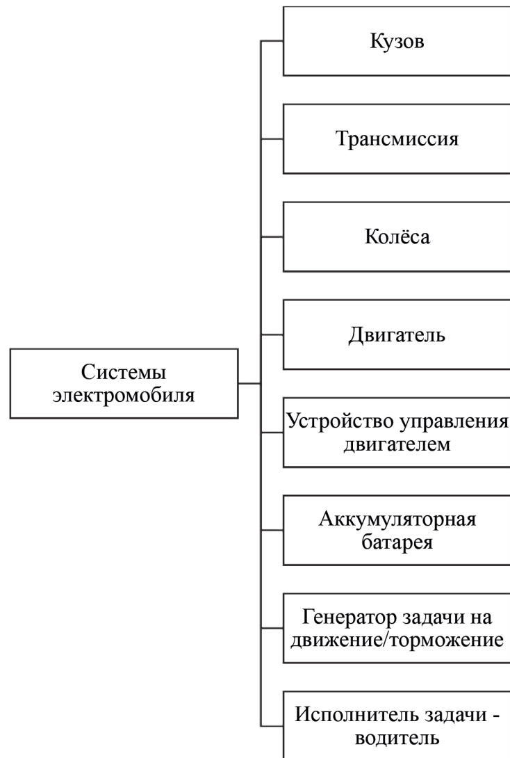
Рисунок 1. Главные системы электромобиля
