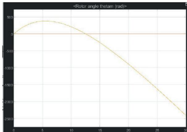
**Рисунок 5.** Осциллограмма угла поворота ротора при снижении напряжения
