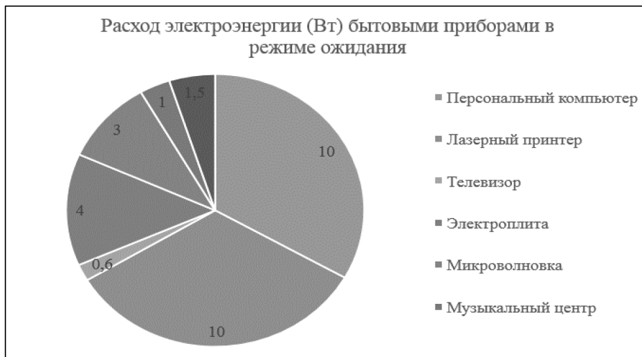
Рисунок 4. Расход электроэнергии бытовыми приборами в режиме ожидания, Вт
