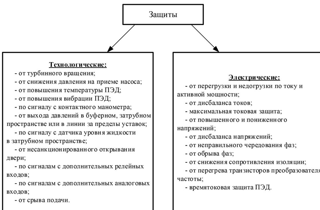
Рисунок 2. Схема защит ПЭЦН
