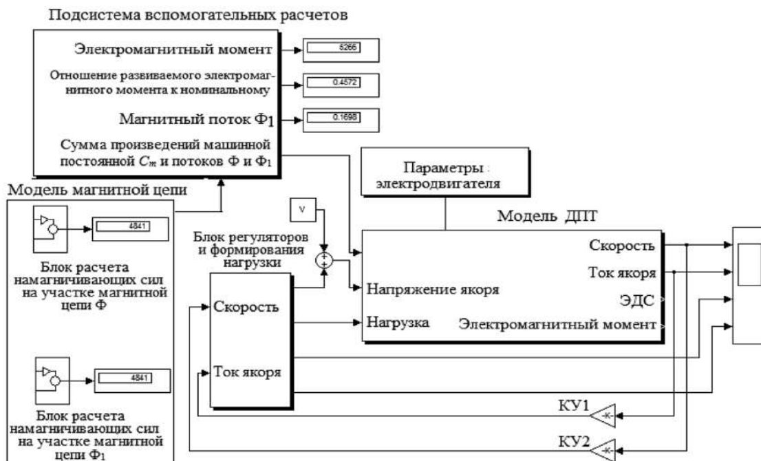
Рисунок 3. Компьютерная модель электротехнического комплекса бурового насоса и расчета магнитной цепи ДПТ при частичном отказе системы возбуждения
