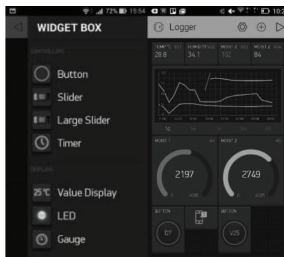
Рисунок 2. Панель инструментов Widget Box облачного сервиса Blynk и пример окна iOS или Android-приложения
