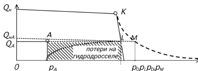
Рисунок 3. Мощностная диаграмма гидропривода с машинно-дроссельным регулированием подачи
