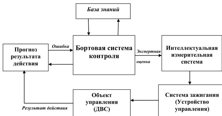
Рисунок 1. Структурная схема интеллектуальной системы диагностики системы зажигания
