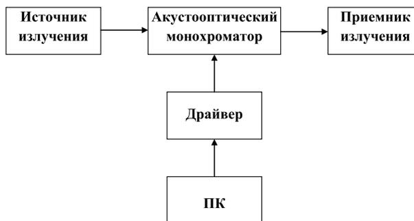
Рисунок 4. Структурная схема калибровочной системы
