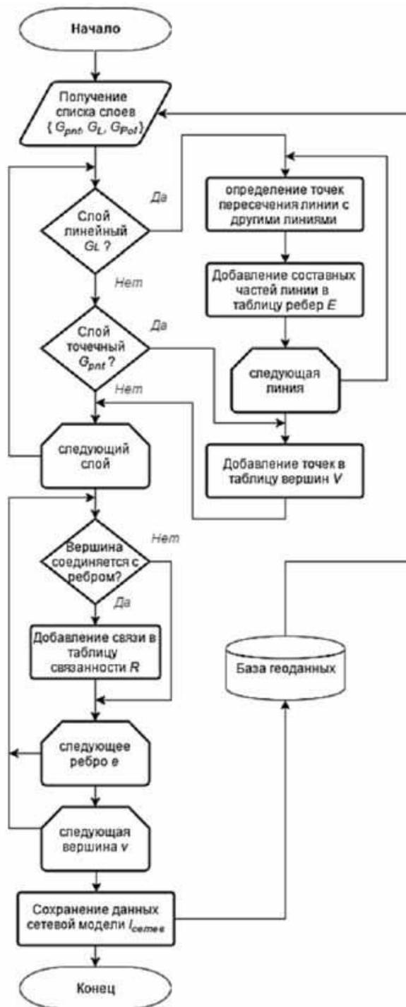
Рисунок 3. Блок-схема получения сетевой модели данных
