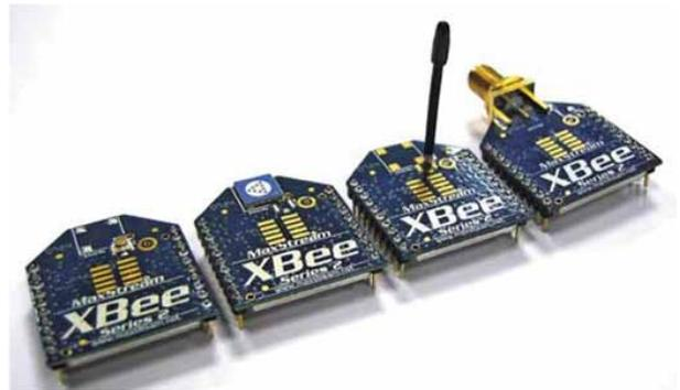
Рисунок 2. Внешний вид XBee-модулей
