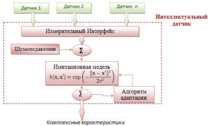
Рисунок 2. Интеллектуальный датчик диагностики уровня ЭМВ от системы зажигания
