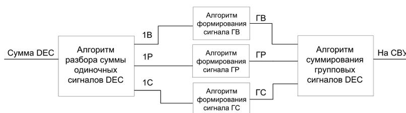
Рисунок 3. Структурная схема метода формирования групповых сигналов
