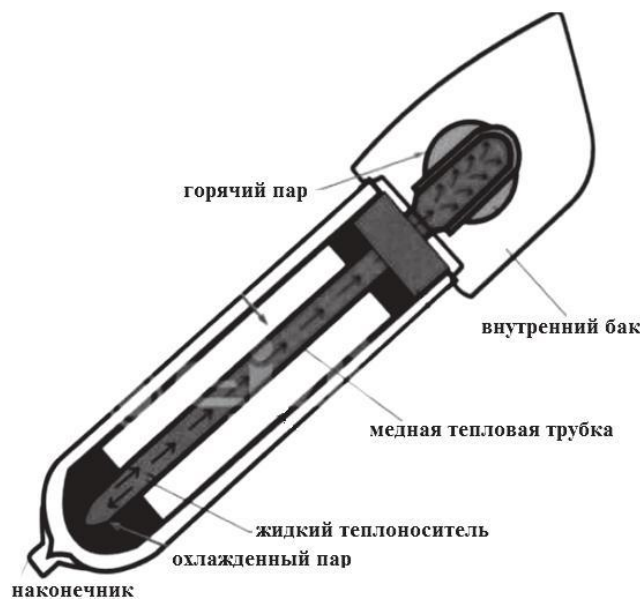
Рис. 1. Конструкция нагревательного элемента солнечного коллектора
