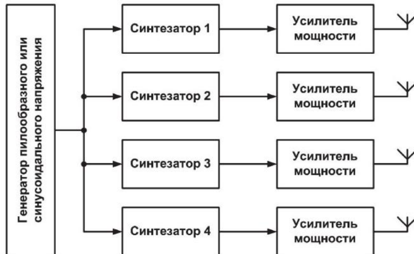
Рис. 2. Структурная схема передатчика помех
