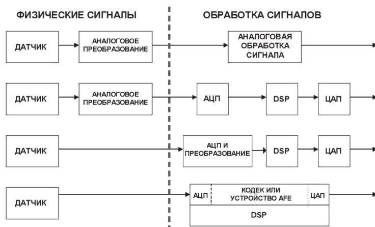
Рис. 1. Схема обработки сигналов в информационно-измерительных системах
