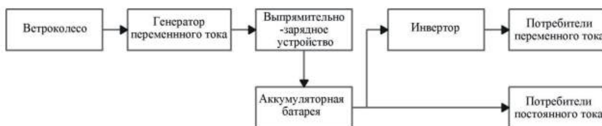
Рисунок 1. Структурная схема автономной ветроэлектростанции с генератором переменного тока, питающей потребителей постоянного и переменного тока
