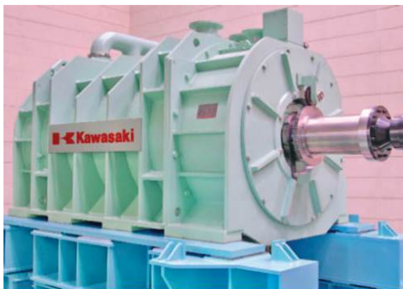
Рисунок 9. ВТСП-электродвигатель японской компании Kawasaki
