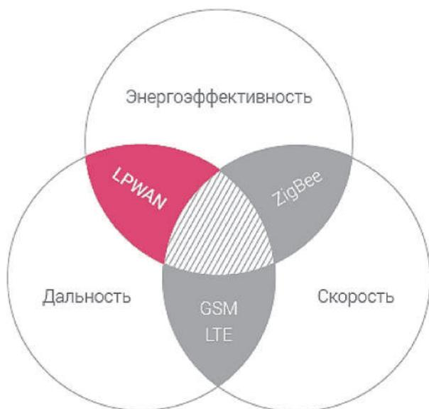
**Рисунок 4.** Сравнительная характеристика наиболее часто используемых беспроводных технологий передачи данных
