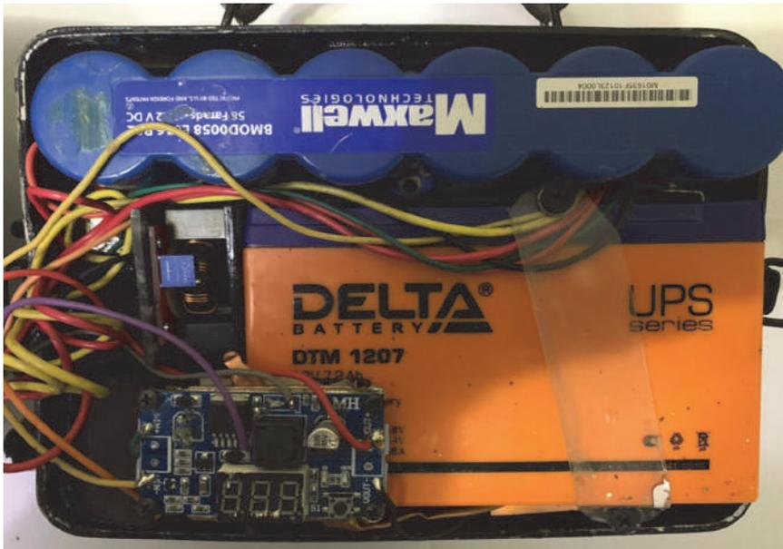
Рисунок 3. Автономное устройство для питания катодной защиты
