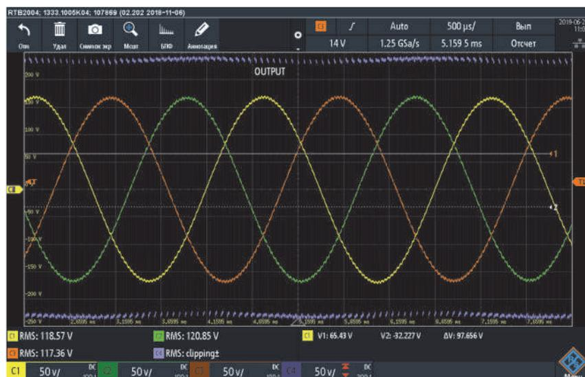
Рисунок 11. Осциллограмма напряжений цепи трехфазного переменного тока
