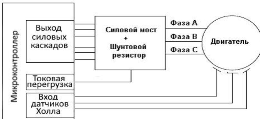
Рисунок 4. Функциональная схема управления БКДПТ
