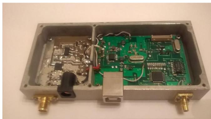
**Рисунок 4.** Драйвер акустического сигнала
