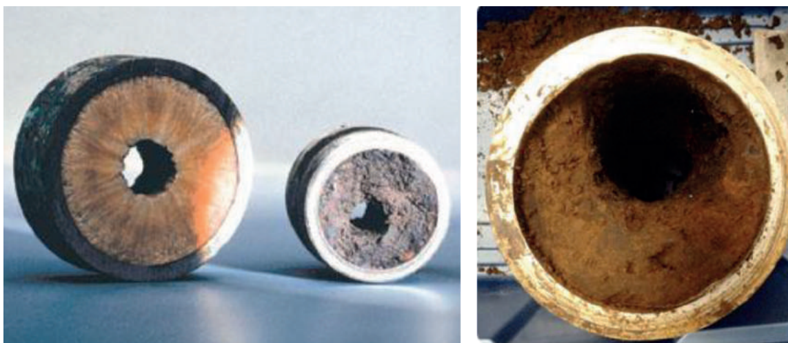
Рисунок 1. Образцы срезов нефтепроводов с АСПО
