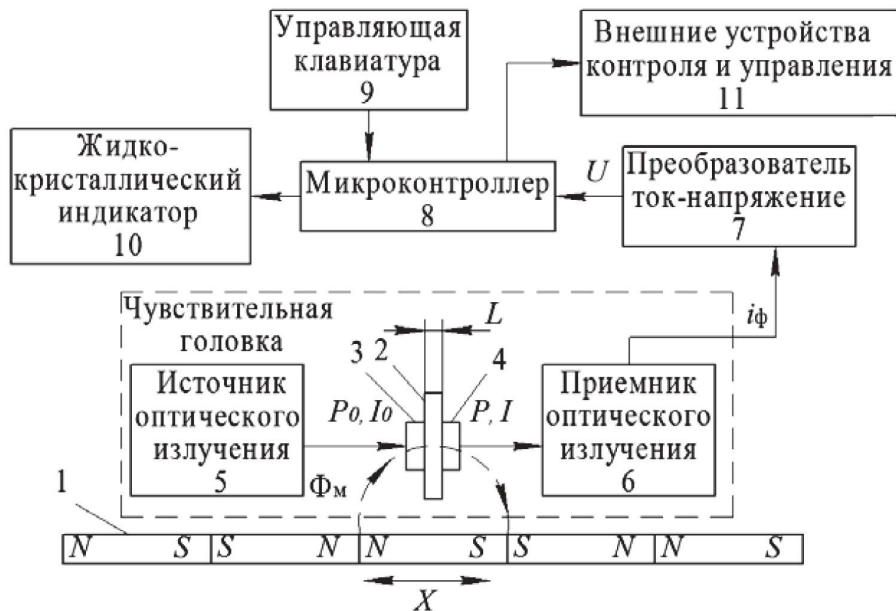
Рис. 8. Преобразователь перемещений с магнитными метками: 1 – подвижный носитель магнитных меток в виде кодовой шкалы; 2 – ФГП; 3 – поляризатор; 4 – анализатор
