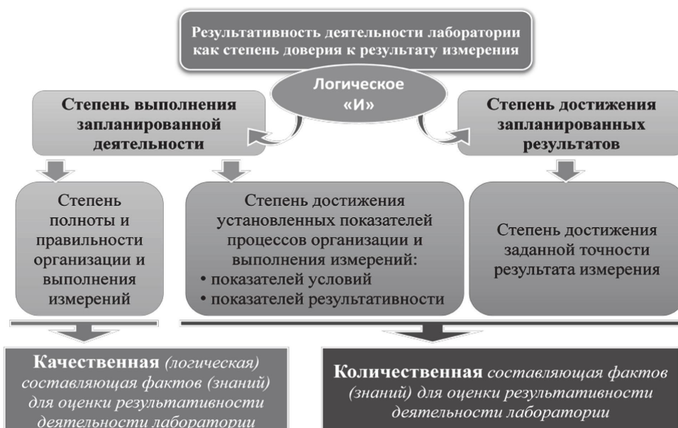
Рис. 1. Схема формирования комплексного показателя результативности процесса измерения (испытания) в соответствии с идеологией стандартов ISO серии 9000
