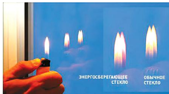
Рис. 2. Отличие энергосберегающего стекла от обычного стеклопакета
