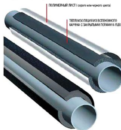
Рис. 1. Изоляция теплопроводов с применением вспененного каучука
