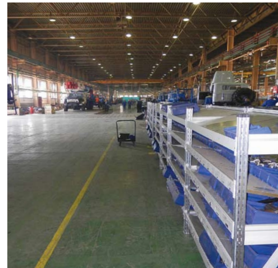
Рис. 2. Стеллажи «супермаркета» ПКИ цеха сборки нефтяной спецтехники ОАО «ПО ЕлАЗ»
