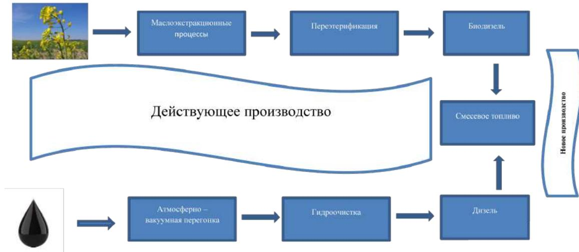
**Рисунок 2.** Принципиальная блок-схема производства инновационной продукции – смешанного топлива
