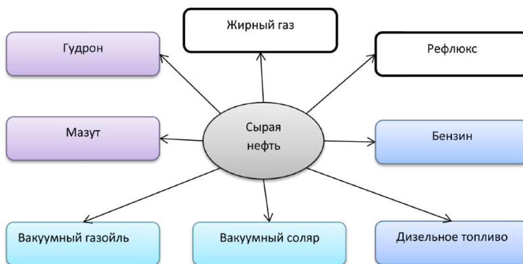
**Рисунок 1.** Номенклатура получаемых продуктов при первичной переработке нефти на установках ЭЛОУ-АВТ
