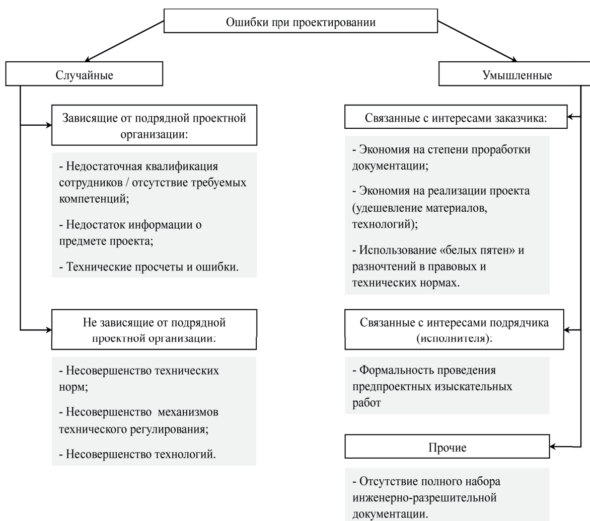
Рисунок 3. Ошибки на стадии проектирования (и причины их возникновения), ведущие к появлению тех или иных рисков
